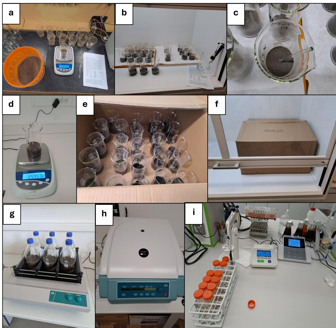
Obrázok 3. Fotodokumentácia z priebehu imobilizačných a extrakčných experimentov s pôdou: (a) naváženie zeminy a činidiel, (b) aplikácia zásobného roztoku liečiv v metanole, (c) premiešavanie obsahu sklenenou tyčinkou do odparenia metanolu, (d) nasýtenie deionizovanou vodou na 50 % WHC a odváženie, (e) uloženie na tmavé miesto, (f) inkubácia v tme, (g) extrakcia vodou rozpustnej frakcie liečiv, (h) centrifugácia, (i) meranie pH a EC supernatantov
