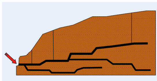
Obr. 5 Explózie termobarickej munície v blízkosti otvorov vnútorných uzavretých priestorov sú nebezpečné aj sekundárnymi tlakovými vlnami, spôsobenými odrazom primárnej vlny od ich stien. Všetky rýchle zmeny tlaku spôsobené výbuchom tu spôsobujú okrem fatálnych zranení v dôsledku nárazov osôb o steny chodieb a zranení letiacimi objektmi, aj rôzne vnútorné zranenia v miestach vyznačujúcich sa skokovou zmenou hustoty tkanív.
