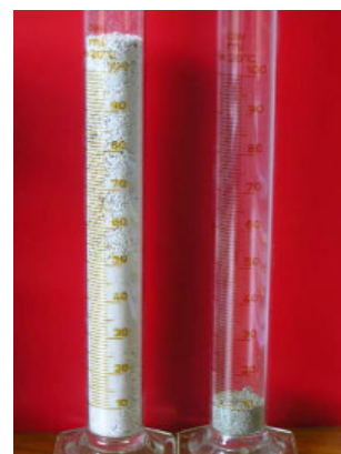
Zmena objemu perlitu po jeho zahriatí na teplotu približne 1000 °C.
