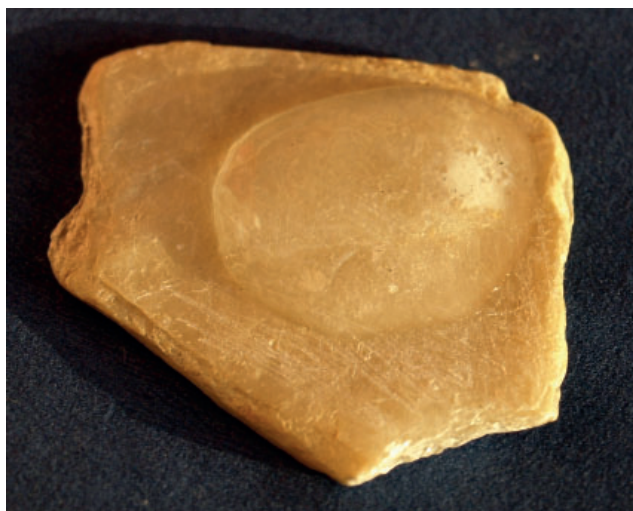
Obrázok dokumentuje hydrofóbný povrch talku. Ten kontrastuje s hydrofílnym povrchom ílových minerálov, ktoré majú veľmi podobnú vrstevnatú štruktúru.
