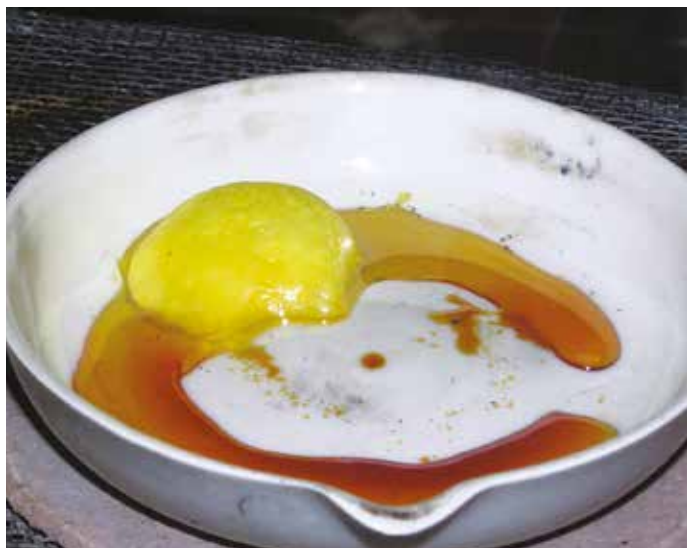
Teplota topenia síry je 115^\circ\text{C} . Kvapalná síra má však vysokú viskozitu, ktorá ju nedovoľuje vytlačiť na povrch z jej hlbinných ložísk. Herman Frasch tento problém vyriešil tak, že ju horúcim vzduchom premenil na penu.
