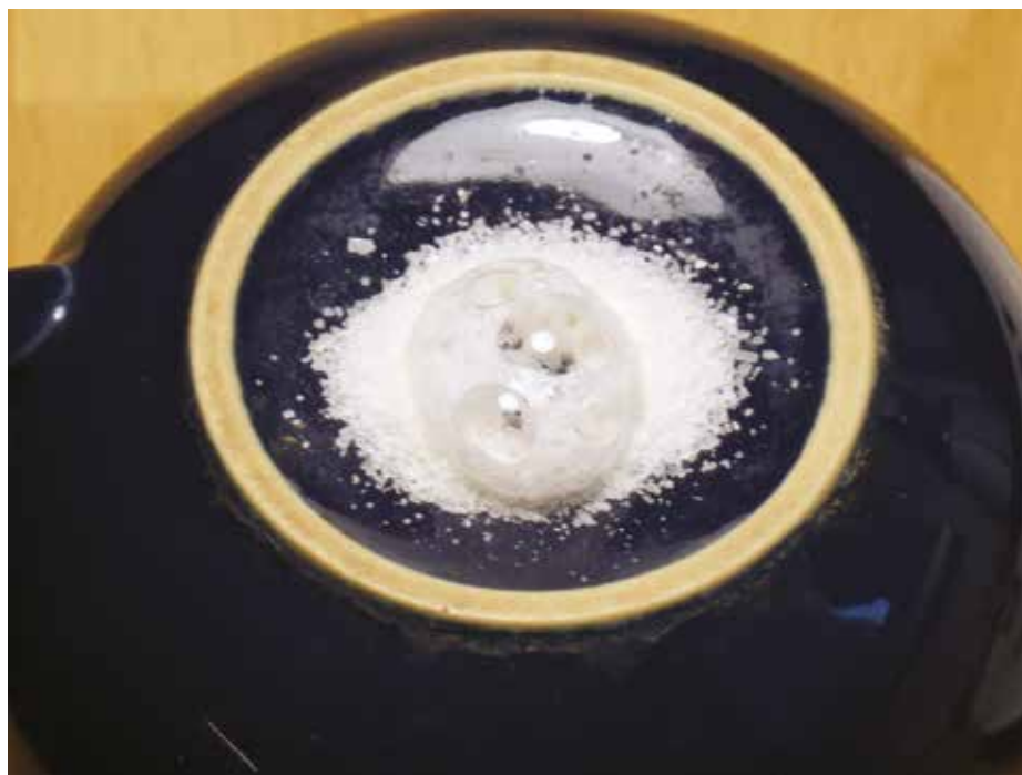
Bublíny pri reakcii kyseliny sírovej s kuchynskou soľou tvoria silne dráždivý chlorovodík (HCl).
