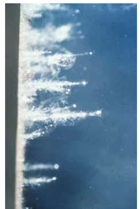
Dráhy prachových častíc v aerogelovom kolektore
