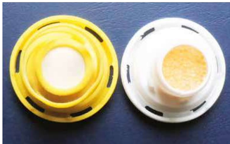
Silikagél je v bežnom živote najčastejšie používaným sorbentom. Slúži na vysušovanie vzduchu pohlcovaním vodných pár.
