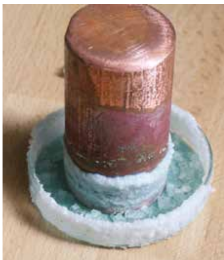
Medený valček. Jeho horná časť je bez koróznej vrstvy, nižšie je povrch pokrytý vrstvou oxidu medného a jeho spodná časť je v dôsledku korózie vodným roztokom chloridu sodného navyše pokrytá aj vrstvou atacamitu a kryštálkami halitu.
