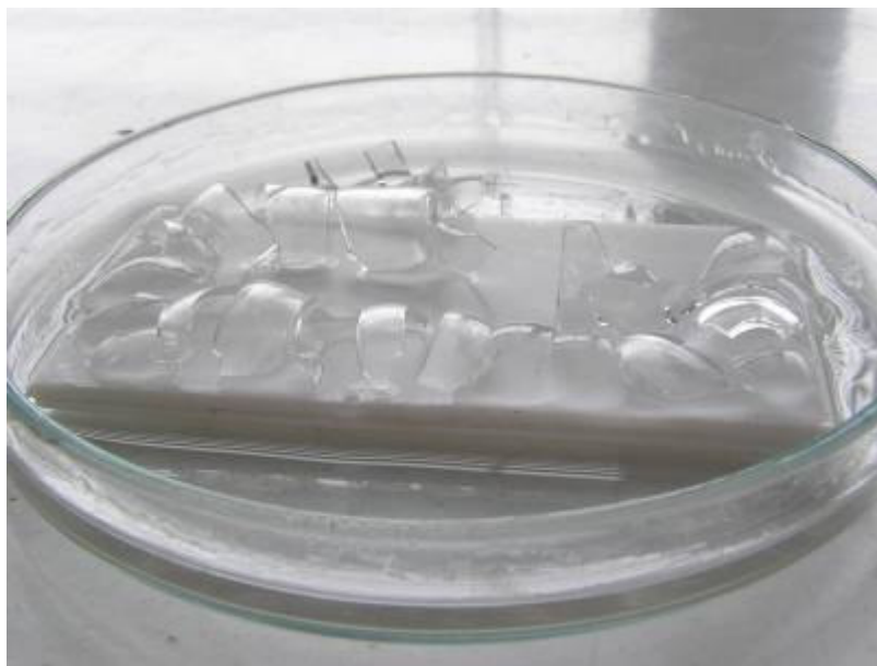
Obr. 9. 7. Ukážka deformácií v \text{SiO}_2 géle, pripravenom z TMOS, metanolu a vody, vznikajúce počas starnutia
